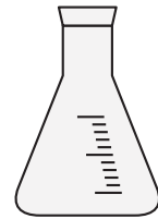
erlenmeyer, ou copo de vidro resistente ao calor, de 250 ou 500 ml
